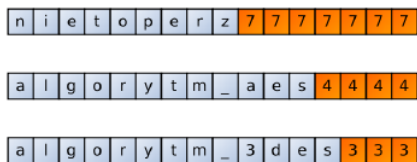
Rysunek 2. Sposób działania paddingu PKCS#7. Dodawane jest N bajtów o wartości N
